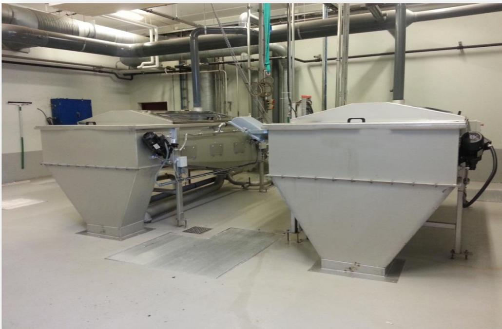
Les boues circulent sur la table d'égouttage, et l'eau facilement extractible en découle à travers des trous perforés dans la toile lors de l'avancement de ces boues vers la sortie de la machine. Le taux de siccité à la sortie peut aller jusqu'à 15% en fonction des produits.
