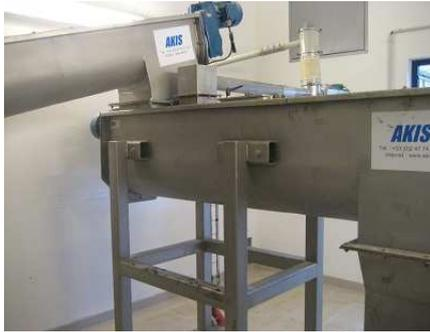
Les vis sont parfaitement adaptées pour le convoyage des produits collants tels que des boues chaulées.
