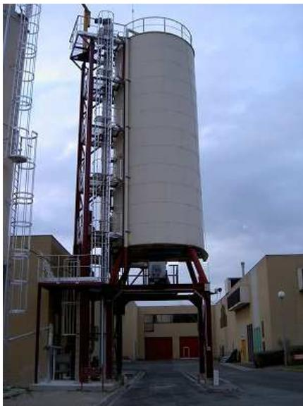
Ici nous avons un système de convoyage vertical pour le malaxage et le convoyage des boues vers un silo de stockage. Les convoyeurs verticaux AKIS sont très fiables et performants. Ils nécessitent peu de maintenance et sont utilisés pour de nombreuses applications, par exemple dans des stations d'épuration ou dans diverses industries.
